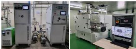
리튬황전지용 5인치/10인치 Roll-To-Roll 전극 제조 장비
